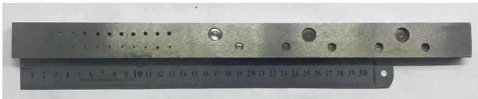
Рис. 5. Прототип стандартного образца предприятия с плоскодонными отверстиями
