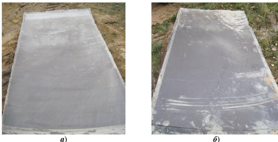
Рис. 4. Внешний вид многослойного металлического материала после сварки взрывом: *а* – 4-слойного с одним внутренним протектором; *б* – 6-слойного с двумя внутренними протекторами
